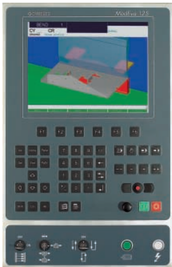
Commande numérique Modeva 12S de Cybelec S.A. Destinée, en premier lieu, au secteur des machines de déformation de métaux, cette commande est modulaire et évolutive. Elle est ainsi destinée à couvrir de nombreuses nouvelles applications.
